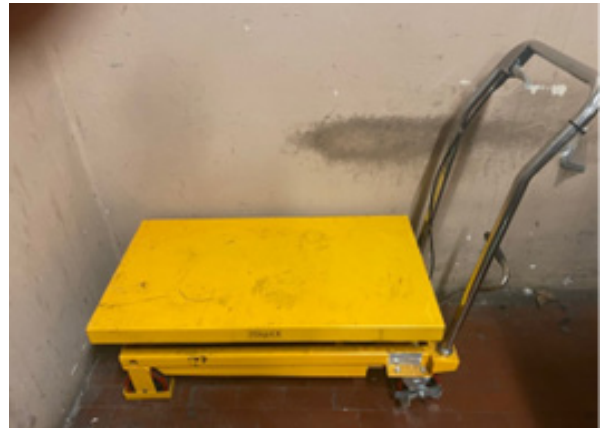
Figura 4 - Nuova attrezzatura fornita: carrello con piano regolabile ad altezza massima di 1.3 metri, in modo da raggiungere i motori della macchina da smontare (precedentemente l'addetto disponeva di un carrello manuale a ripiano fisso, ed effettuava una movimentazione manuale in presenza di dislivello verticale)
