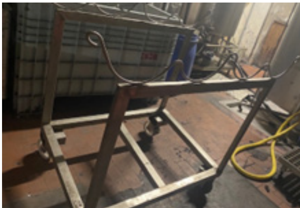
Figura 5 - Nuova attrezzatura fornita: carrello conformato per appoggiare e spostare i cilindri delle macchine di stampa vigoureaux (peso kg 30). Precedentemente l'addetto movimentava i cilindri manualmente, con necessità di doppio spostamento e trasporto a/da piano di appoggio fisso
